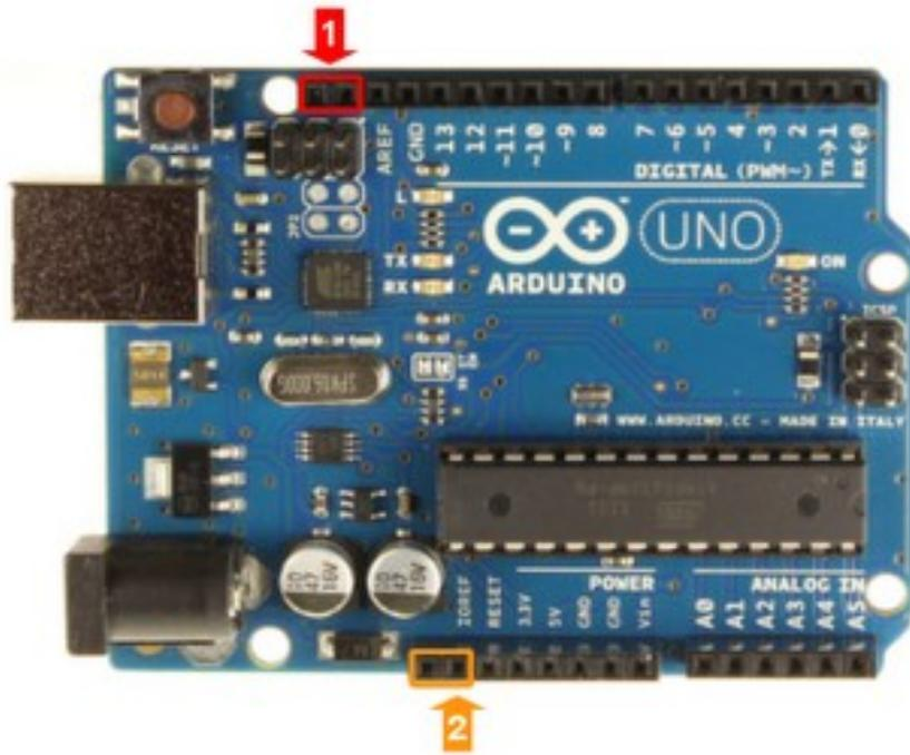
La board Arduino UNO ha subito una revisione del hardware rispetto alle precedenti rev1 e rev2 con introduzione del **pinout 1.0** e altre piccole modifiche, mantenendo la compatibilità hardware e software con le precedenti. Sono state introdotte:
