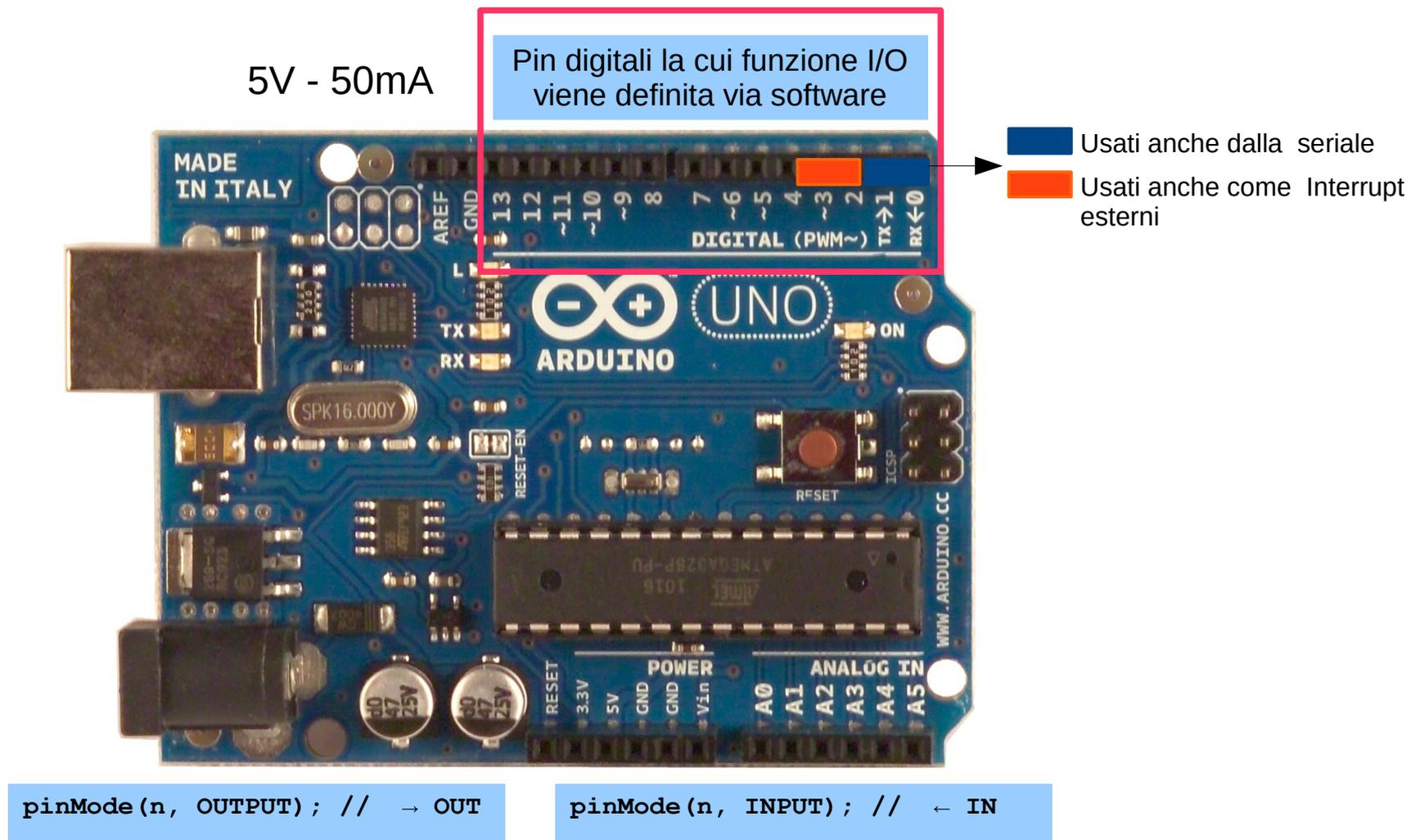
Se si usa i pin 0 e 1 nel progetto, quando si programma la board si consiglia di lasciare liberi tali pin per evitare interferenze. Questi sono usati per la programmazione tramite il chip convertitore seriale/USB
